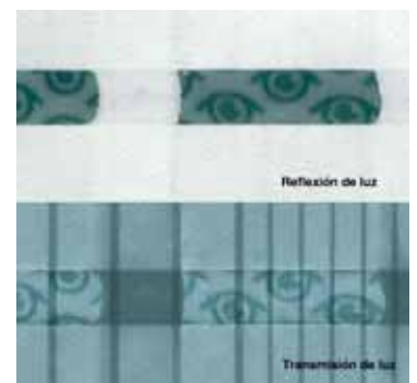
Vista del hilo Motion por reflexión y transmisión de la luz.
