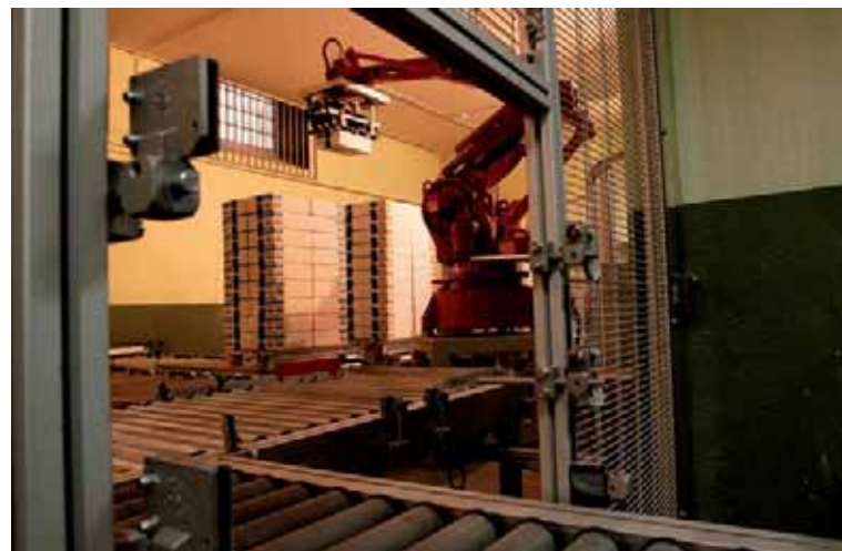
Formación y empaquetado automático de paletas con robot. RCM-FNMT.
