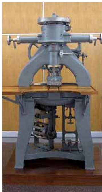
Máquina inglesa «Johnston» (1919), de relieve gráfico, capaz de imprimir un billete cada vez, a una velocidad de 550 impresiones/hora. La grabación tiene lugar plano contra plano. La limpieza de la grabación se efectúa en seco mediante papel; la colocación de la hoja y su retirada después de la impresión se realizan a mano (Banca d'Italia, Museo del billete).
