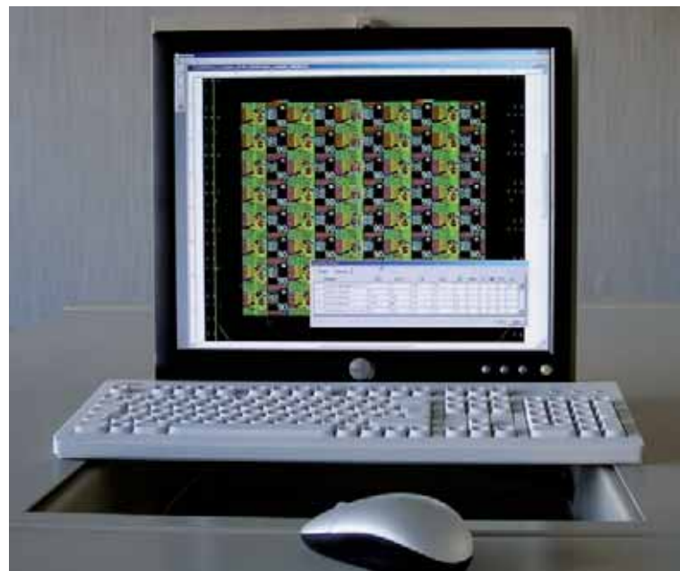
Estación de trabajo que controla el proceso de grabado de planchas calcográficas mediante láser.
